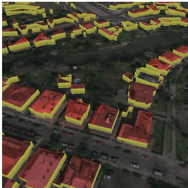
Abbildung 7.11: Konvertierungsergebnisse der Gebäudegrundrisse aus den DXF-Daten. Die Gebäudehöhen sind Zufallswerte.
