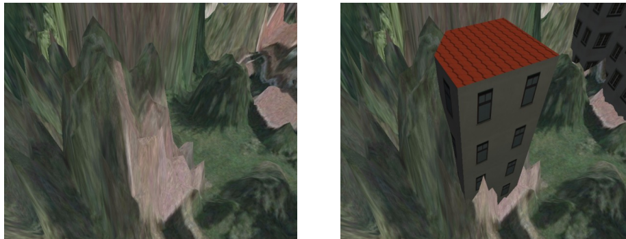
Abbildung 7.15: Die Wahl der maximalen Höhe innerhalb des Grundrisses für die Gebäudehöhe des Blockmodells kann zu starken Artefakten führen wie bei diesem einstöckigen Gartenhäuschen neben hohen Bäumen, die in den Grundriss hineinragen.
