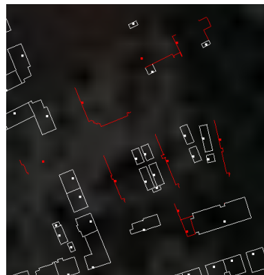
Abbildung 7.14: Probleme mit Gebäudegrundrissen: Übersicht und zwei Detailansichten: weiß : Fehlerlos erkannte Gebäude mit meist korrekten Grundrissen; rot : Gebäude ohne zusammenhängenden Grundriss; blau : Flächen ohne Schraffuren
