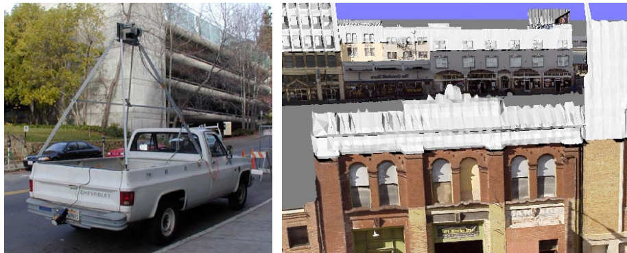
Abbildung 4.8: links : Aufnahmefahrzeug mit Laserscannern und Kamera. rechts : Ergebnisse. Wegen des beschränkten Sichtfeldes der Kamera ist der obere Teil der Fassaden nicht texturiert. (Quelle: Video & Image Processing Lab, Berkeley )
