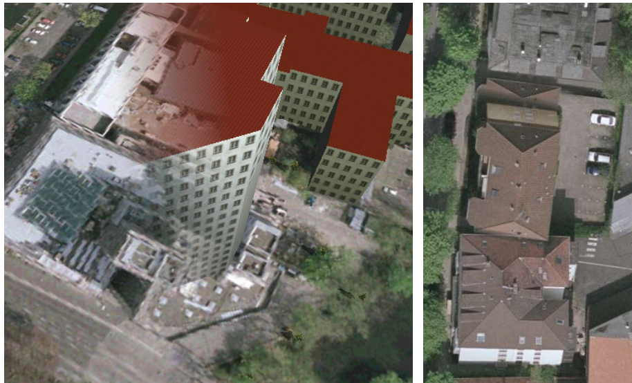
Abbildung 4.7: Artefakte von Orthofotos: links : Trotz guter Übereinstimmung des Grundrisses auf Höhe des Erdbodens ist das Bild des Daches um mehrere Meter verschoben; rechts : An der Grenze zwischen zwei zusammengeführten Fotos sieht man Hauswände aus unterschiedlichen Perspektiven und einen wiederholten Dachrand
