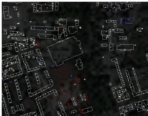
Abbildung 7.14: Probleme mit Gebäudegrundrissen: Übersicht und zwei Detailansichten: weiß : Fehlerlos erkannte Gebäude mit meist korrekten Grundrissen; rot : Gebäude ohne zusammenhängenden Grundriss; blau : Flächen ohne Schraffuren
