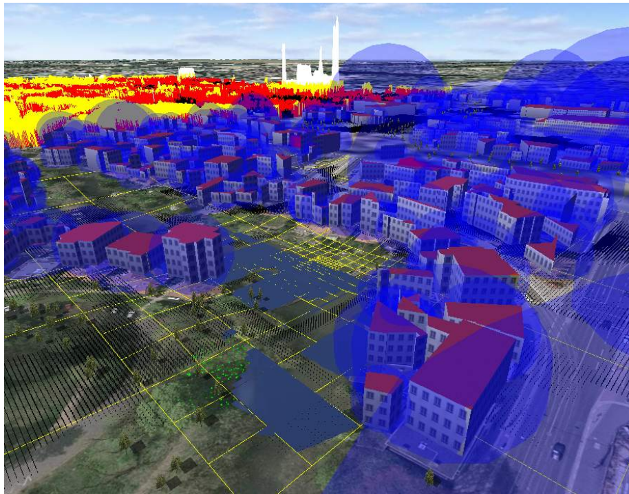
Abbildung 7.9: Eigene Terrain-Engine im Einsatz. Das DGM ist hier mit Hilfe des im Hintergrund sichtbaren DOMs selbst generiert. Die Gebäude sind zu Testzwecken von ihren grob approximierten Bounding Spheres umgeben.
