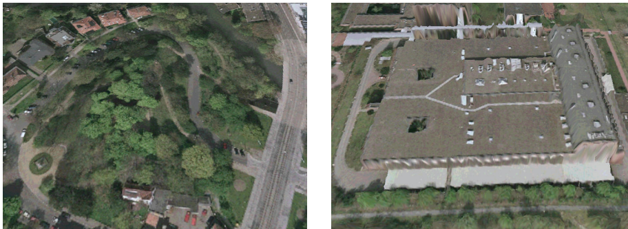
Abbildung 4.3: Größenvergleich: Bei der Erstellung eines DGMs soll der Gaußberg (links) erhalten bleiben, das große Gebäude rechts jedoch weggefiltert werden.
