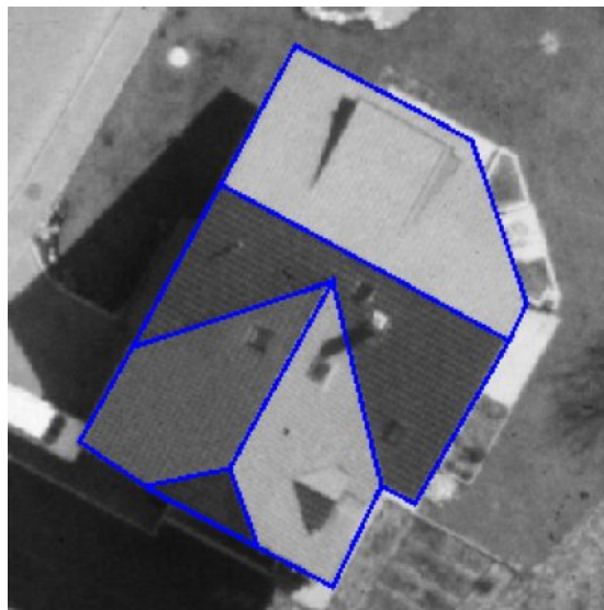
Abbildung 5.10: Ergebnis einer automatischen Gebäuderekonstruktion (Quelle: [Sha00])
